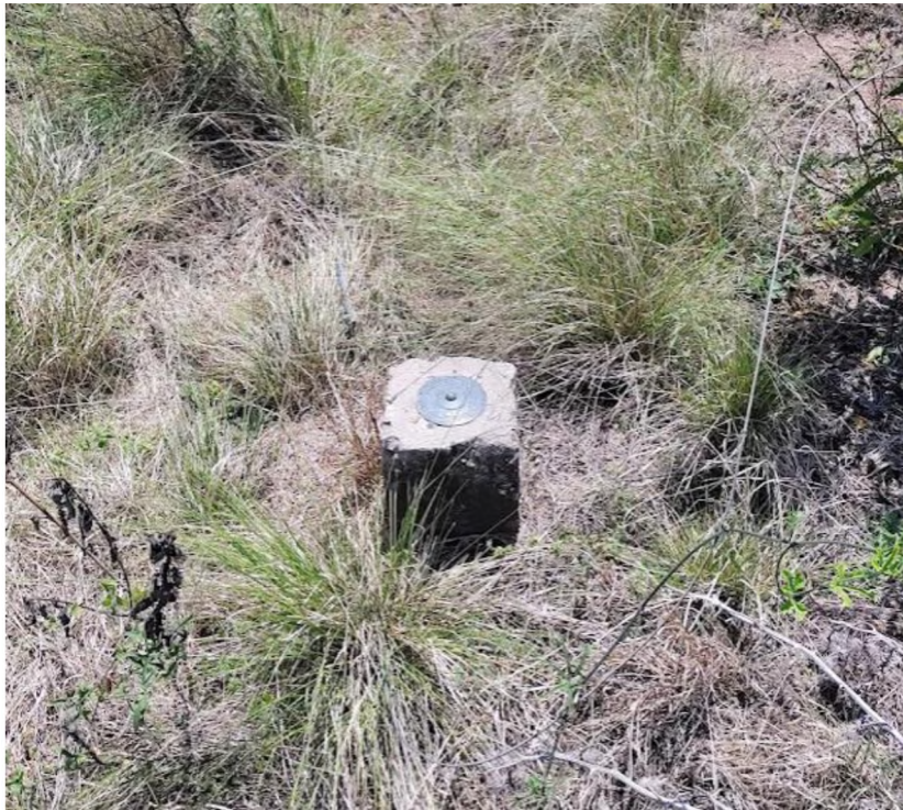
Figura 2.9. Punto fijo PF16N(275) utilizado como punto de apoyo.
