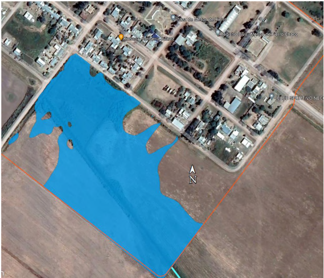
Figura 3.27. Mancha de inundación acumulada en la zona del reservorio generada por la tormenta de 25 años de tiempo de recurrencia y 10 horas de duración. Cota de pelo de agua alcanzado: 83,95m. Permanencia del nivel máximo de inundación: 1h42m. Superficie inundada: 5,42 hectáreas.
