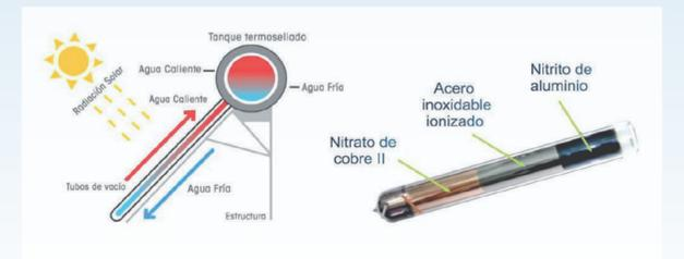
Por eficiencia, funcionamiento y costo para nuestra zona se optó por usar el Termotanque Atmosférico el cual, además dispone de un termostato y una resistencia eléctrica como respaldo en caso que no se alcancen las temperaturas deseadas, sin necesidad de un termotanque de respaldo.
