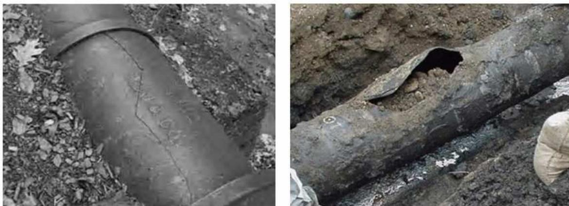
**Figura 1-3 Rotura de cañerías.**
