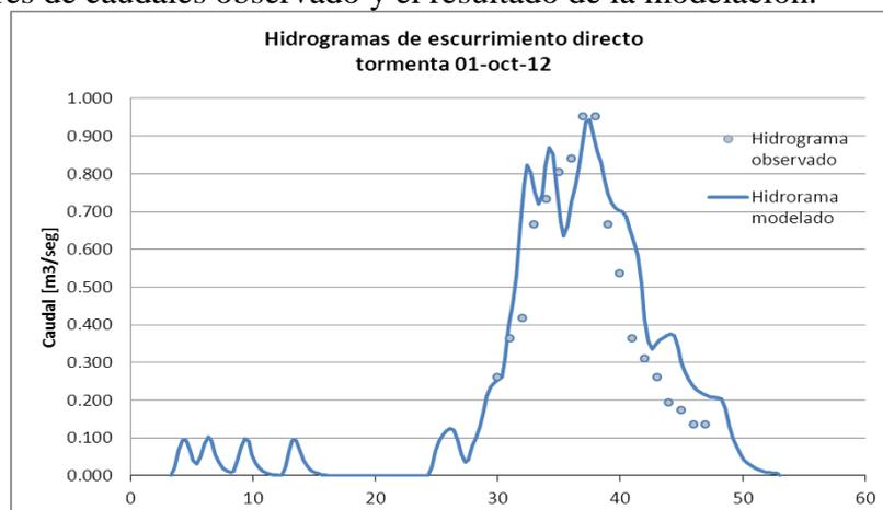
Figura 7. Hidrogramas medido y modelado, tormenta 1-oct-2012.
