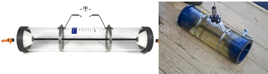
Figura III.3. Muestreador de teflón con cierre automático tipo Van Dorm.
