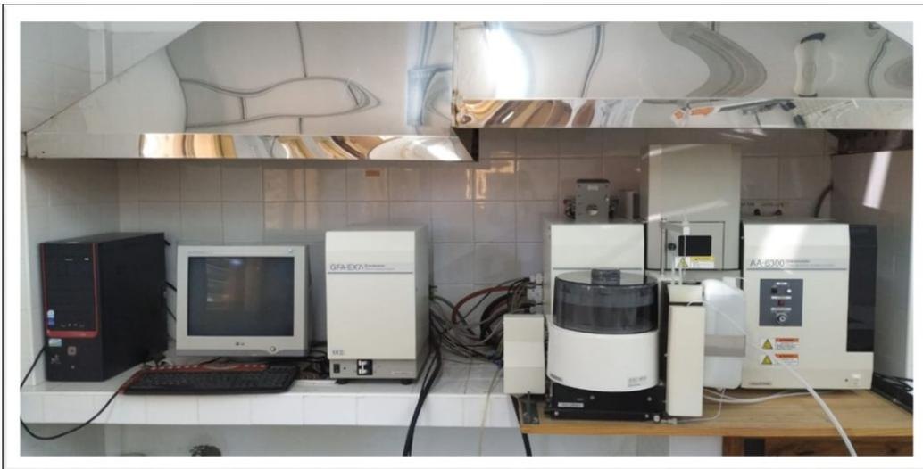
Figura III.5. Equipo AA 6300 Shimadzu.
