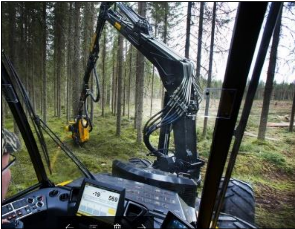
Figura 6. Cabina de cosechadora forestal equipada con comandos y monitores de control de registro de datos. Tomado de Ponsse, 2017.
