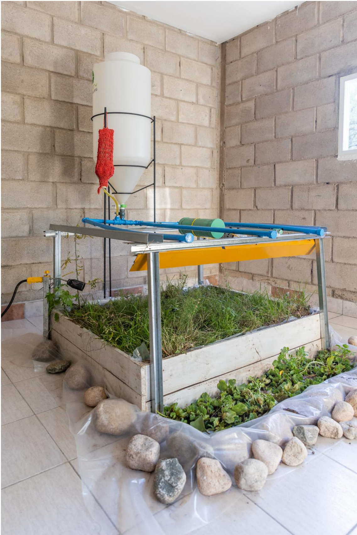
Fig. 45- Construcción de la Nature Machine terminada.
