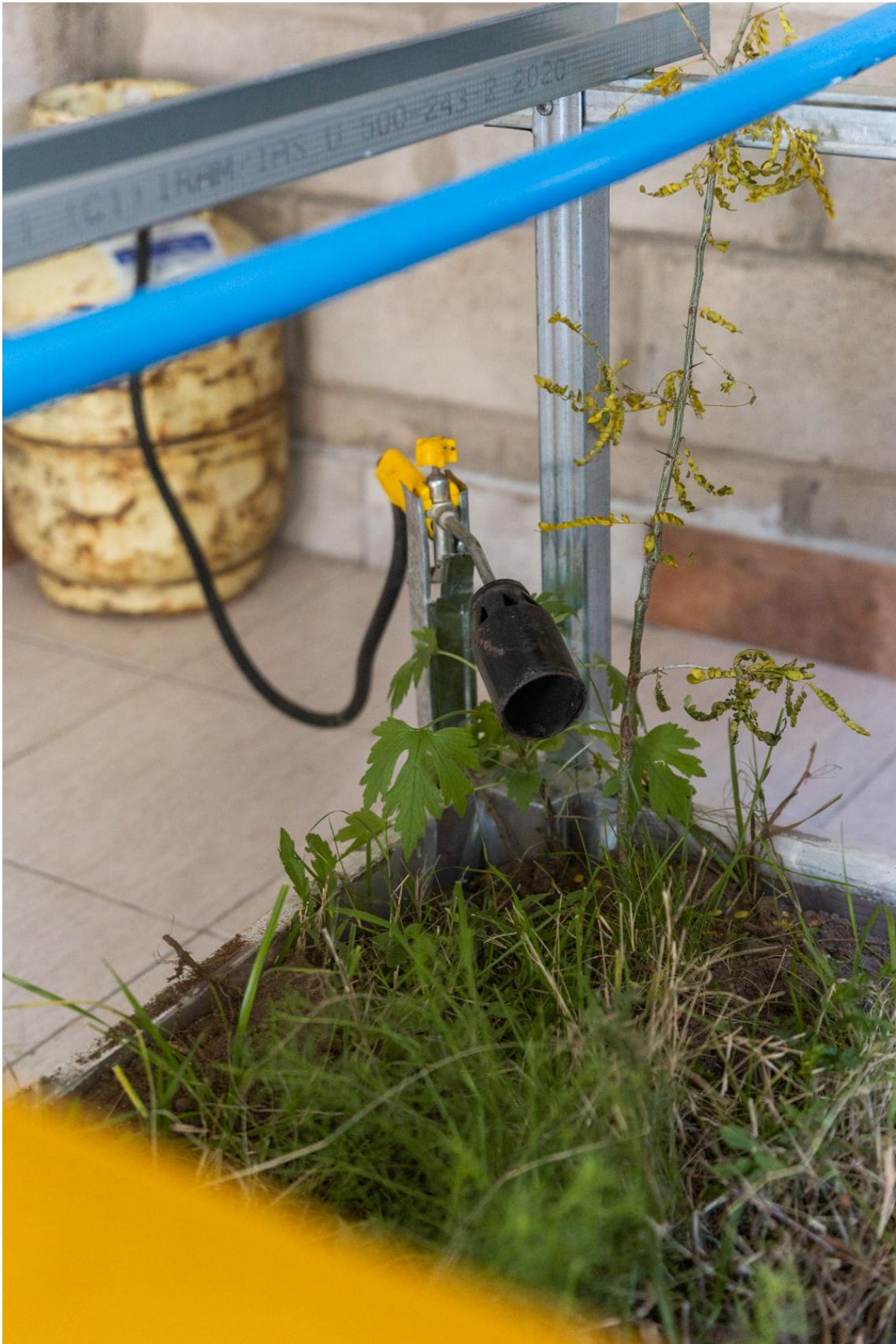
Fig. 53- Detalle donde se observa el soplete a gas butano.
