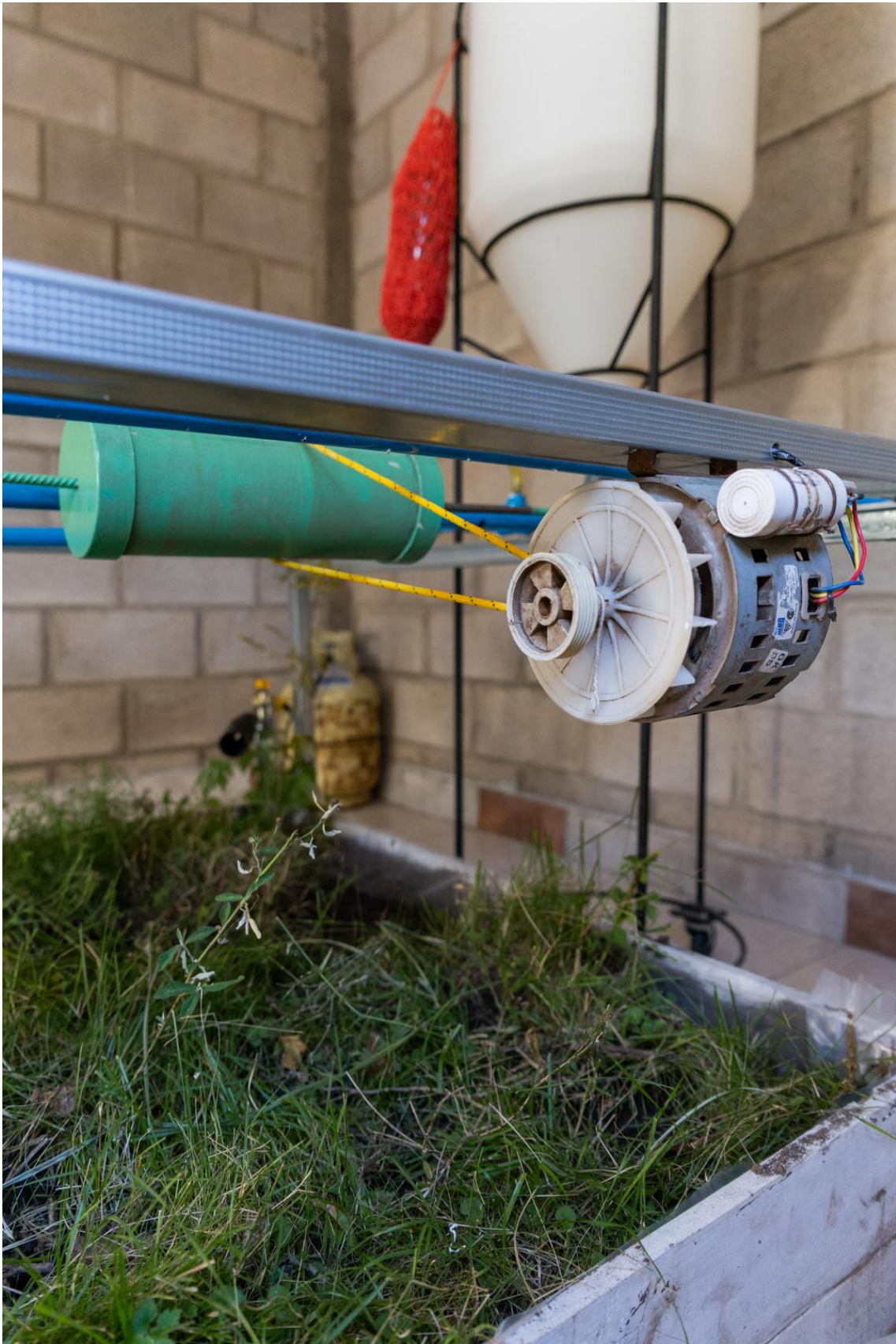
Fig. 47- Detalle donde se puede ver el motor que hace girar la cápsula que contiene semillas y esporas.
