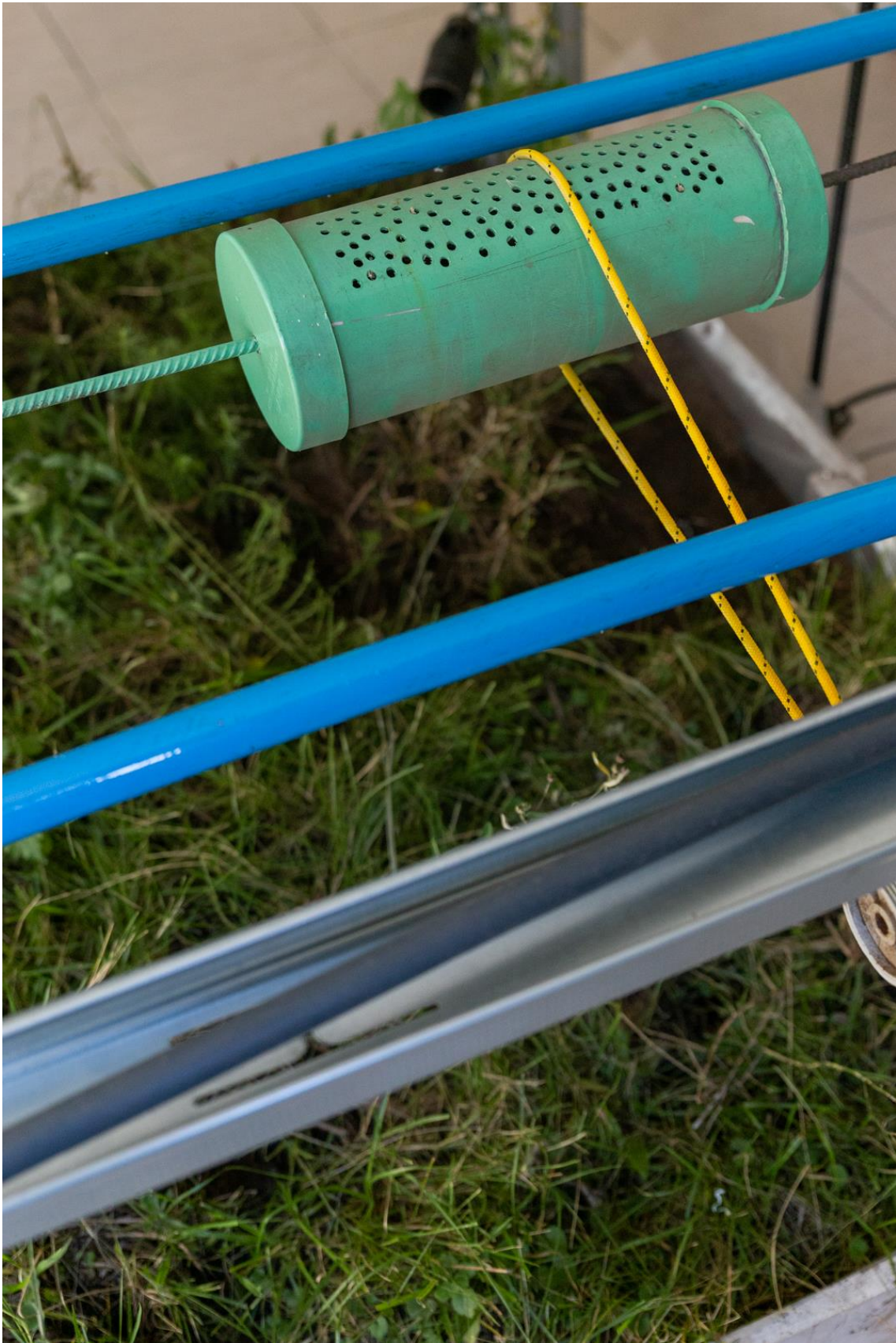
Fig. 48- Detalle donde se puede ver claramente los orificios de la cápsula que contiene semillas y esporas. En celeste caños para el riego con líquidos.
