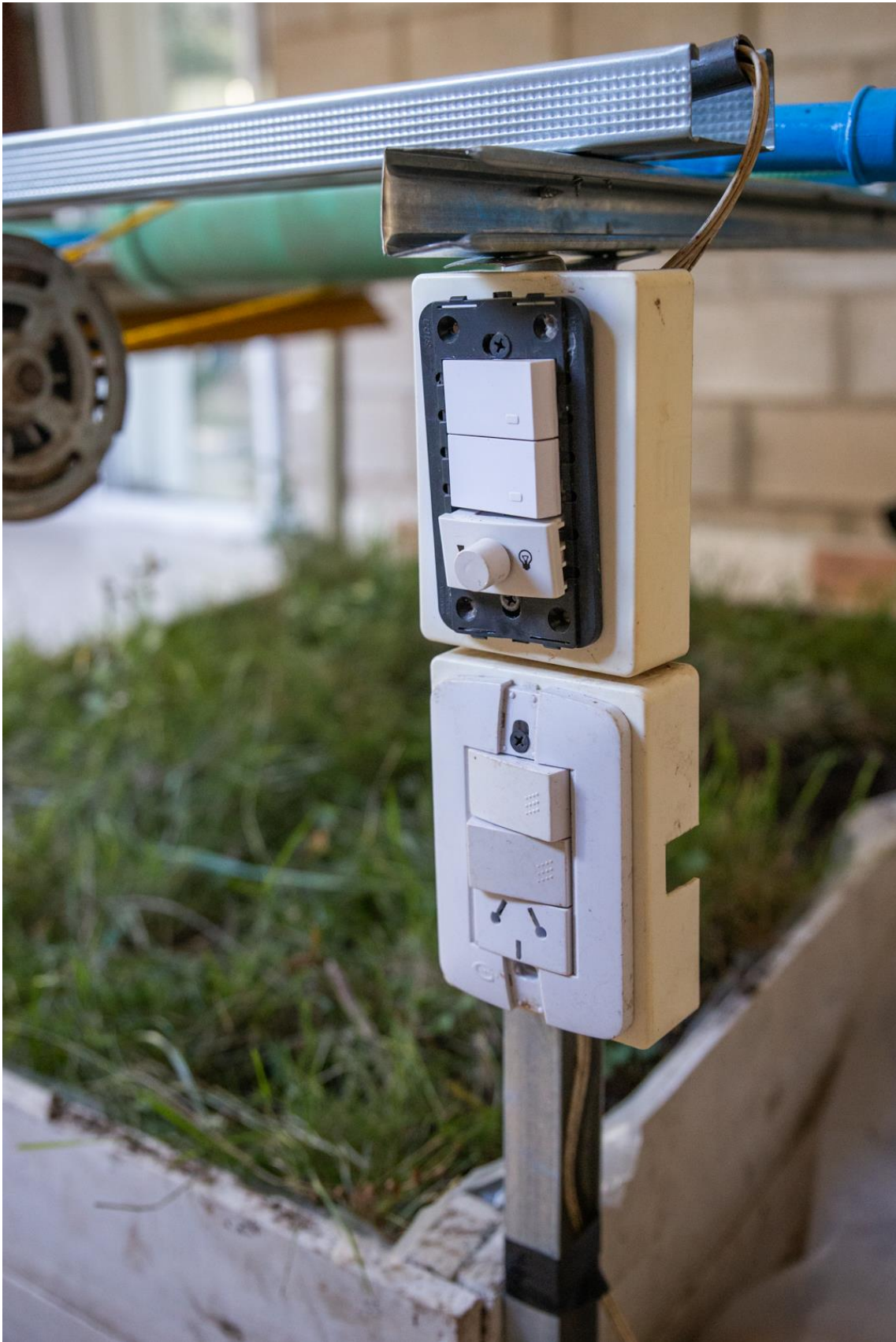
Fig. 54- Detalle del sistema de control, donde se pueden ver los botones y el dimerizador. La caja inferior con el tomacorriente, aunque no se utilizó en esta ocasión, permite la conexión de otros dispositivos a la máquina.
