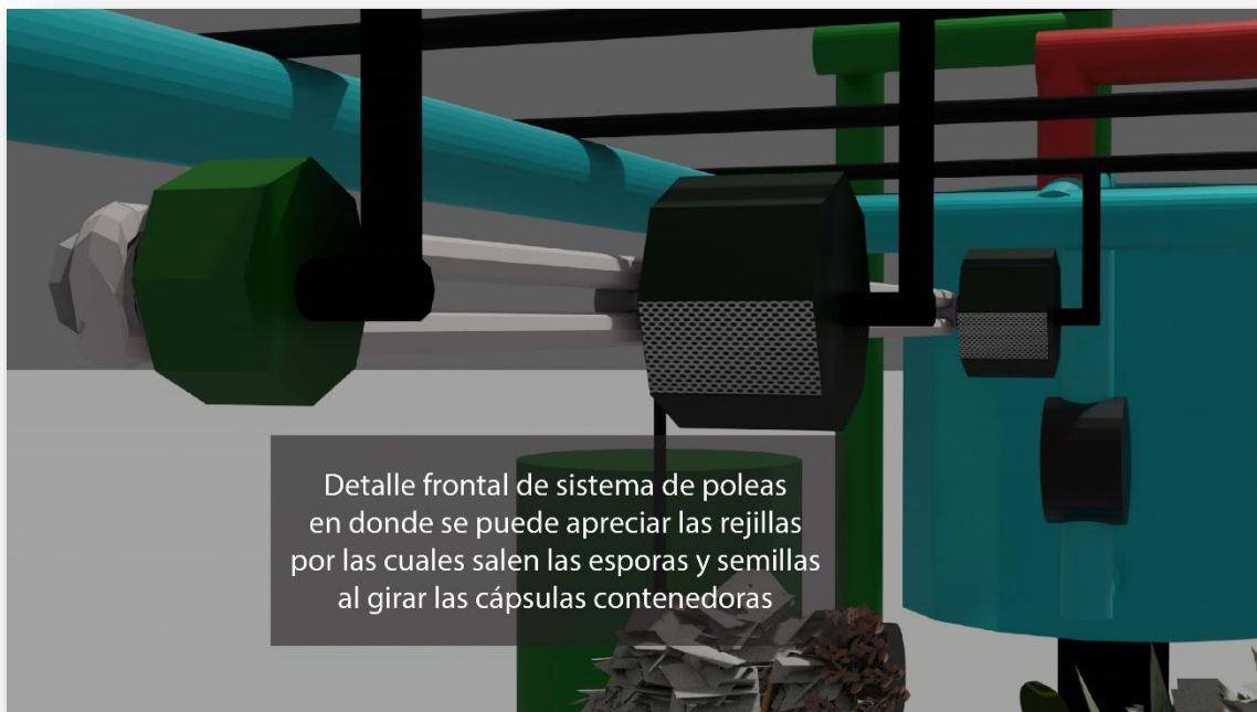
Fig. 14- Detalle de sistema de rociado de semillas y esporas (generado en Blender).
