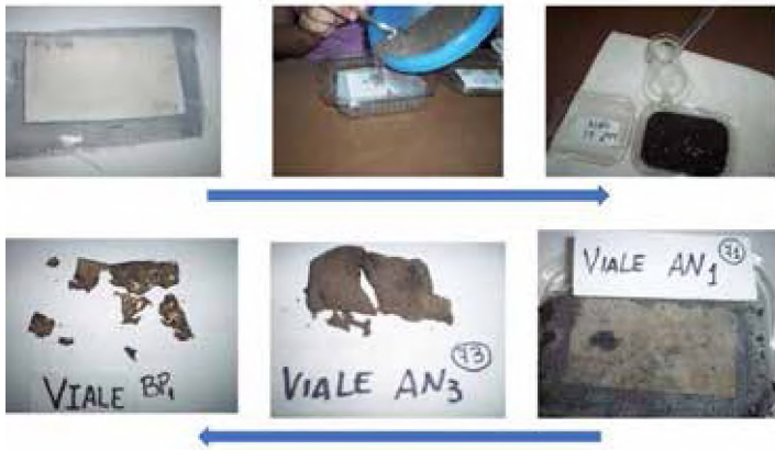
Figura N° 6. Secuencia para el armado y control de la metodología empleada para evaluar la degradación de celulosa en miniredes. Incubación de 45 días con humedad constante y temperatura controlada (Cátedra de Microbiología Agrícola de la FCA-UNNE).
