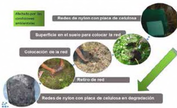
Figura N° 8. Representación esquemática de la metodología empleada para evaluar la degradación de celulosa a campo.
