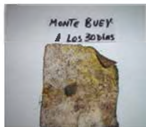
Figura N° 9. Redes de degradación. Degradación en el campo luego de 30 días con escasas precipitaciones (Cátedra de Microbiología Agrícola de la FCA-UNNE).
