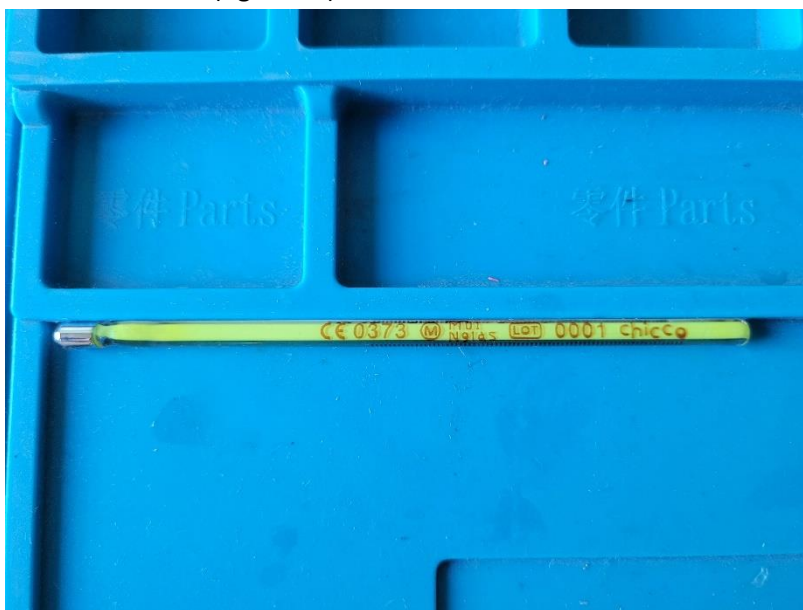
Figure 38: Termómetro de Galio utilizado como "Patrón".
