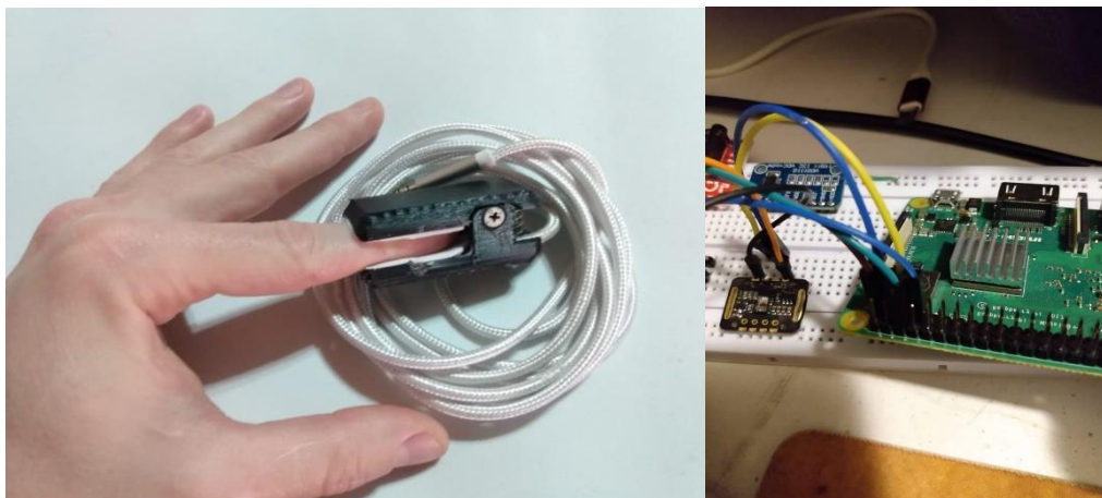
Figure 19: Montaje terminado y prueba con sensor en Protoboard.
