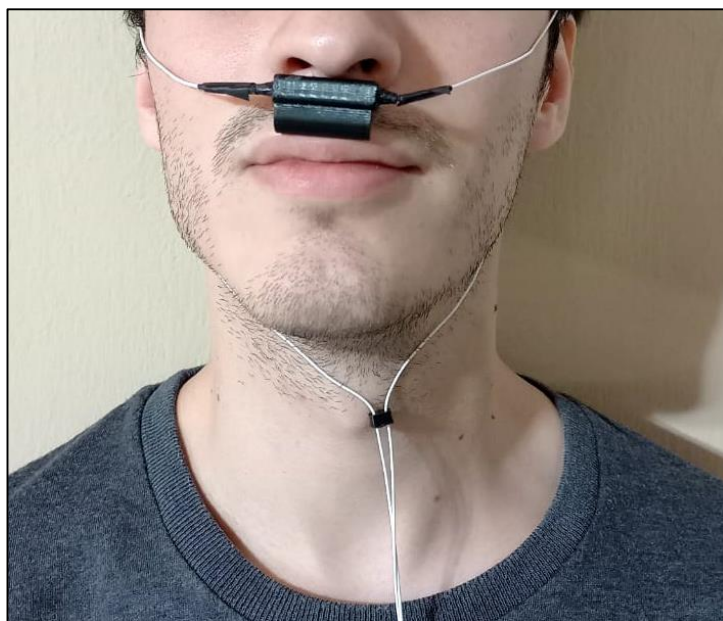
Figure 23: Diseño 3D y montaje final del sensor de FR.
