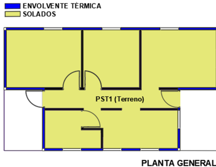
Figura 47: Identificación de los elementos de la envolvente térmica. SOLADOS. Fuente: Elaboración propia.
