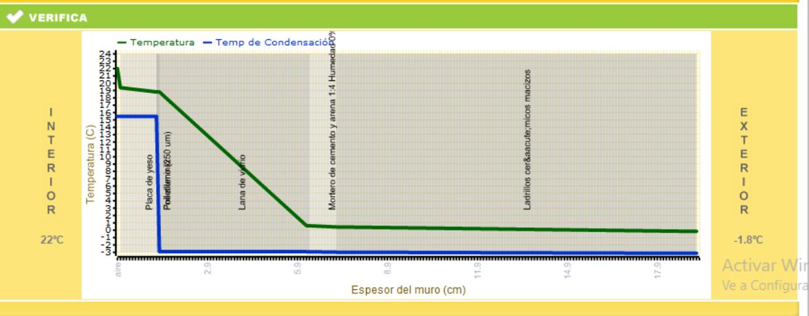
**Nota:** Se puede observar que el muro existente cumple con las condiciones de confort, sin embargo, en los meses más calurosos del año (diciembre, enero y parte de febrero) se debe reforzar con el uso de aires acondicionados dentro de la casa.
