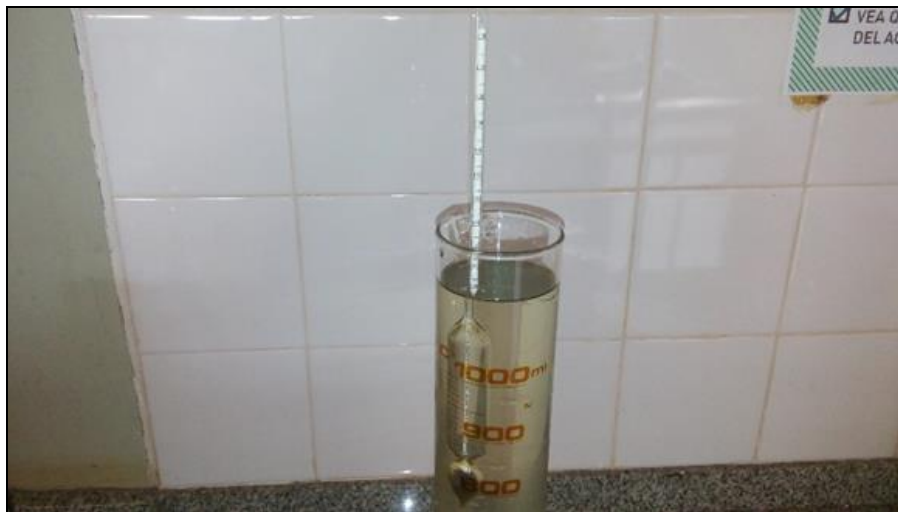
Figura 10: Preparación de la solución de Benbrook y medición de la densidad con el densímetro.
