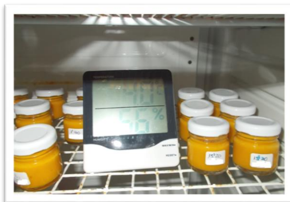
Figura 4.39. Puré de mango tratado térmicamente a 90 °C durante 1 y 15 minutos y almacenado a 4 °C.
