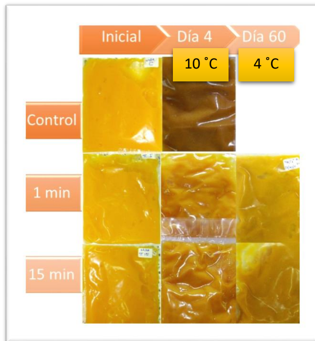
Figura 4.12. Puré de mango control al tiempo inicial y luego de 4 días de almacenamiento a 10 °C; purés tratados durante 1 y 15 minutos al tiempo inicial, luego de 4 días de almacenamiento a 10 °C y luego de 60 días de almacenamiento a 4 °C.
