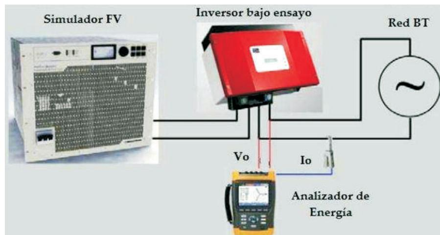
Figura 3.- Diseño esquemático de la forma de operación del banco de ensayo de inversores para uso en SFCR. Fuente: Prieb (2011) [12].
