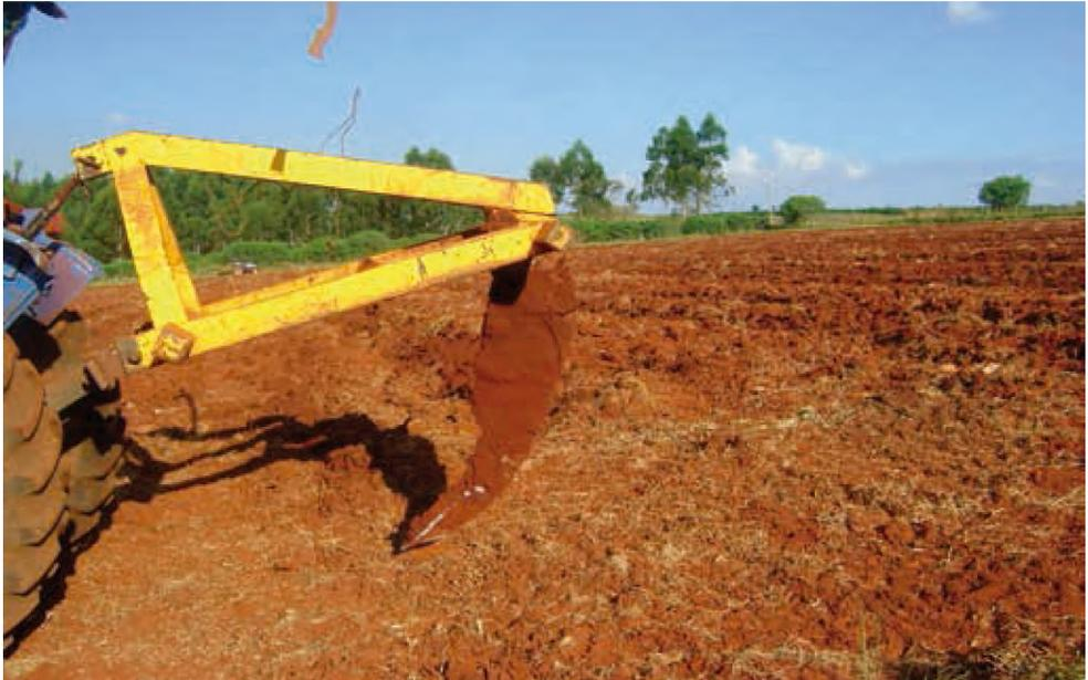
Figura 2: Implemento conocido como subsolador para realizar una labranza vertical.
