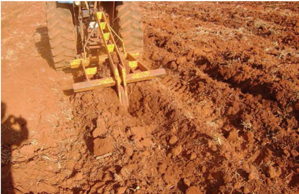
Figura 3: Subsolador trabajando a la máxima profundidad.
