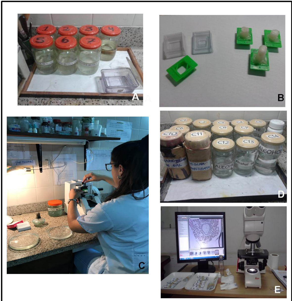
Figura 2.6. Etapas del procesamiento histológico convencional. Deshidratación (A); cofección de tacos (B); cortes con micrótopo (C); coloración (D); observación y análisis (E).
