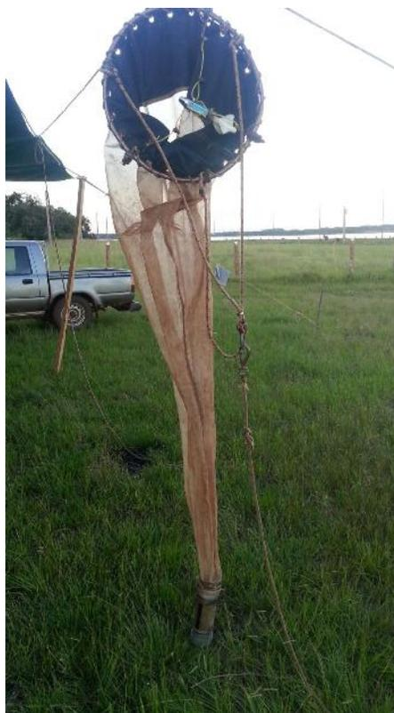
Figura 5. Red de ictioplancton con correntómetro mecánico y vaso colector.
